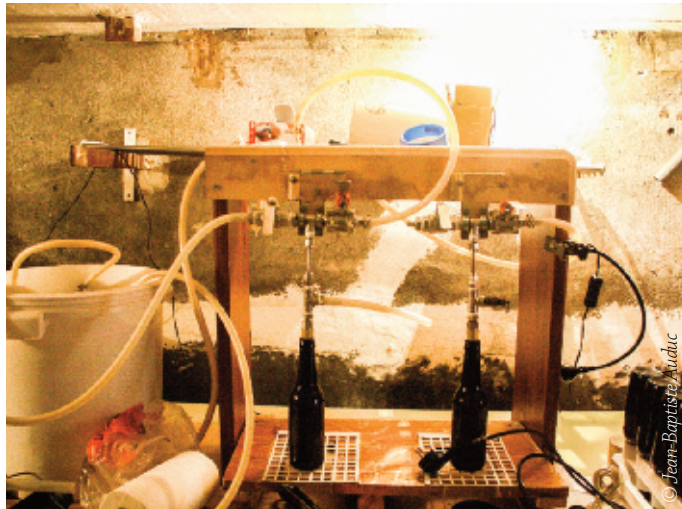
En-haut : Embouteilleuse artisanale de la brasserie Irvoy.
